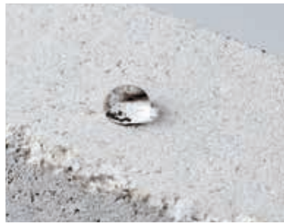
Al aplicar una impregnación hidrofugante, las gotas de agua se deslizan por la superficie.
