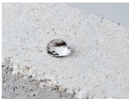
Com a impregnação hidrofóbica, a água forma gotículas e escorre.
