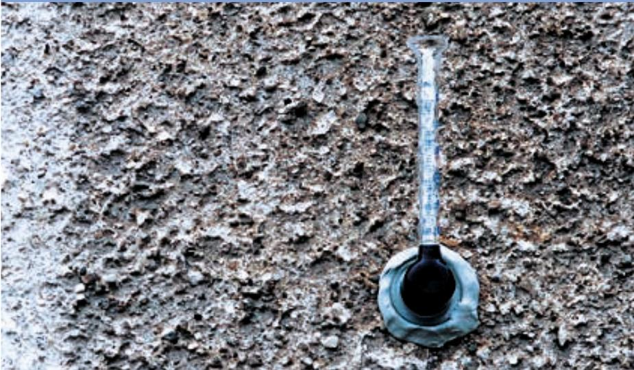
Usando o método do tubo Karsten para testar a hidrorrepelência da mesma fachada em 1997.
