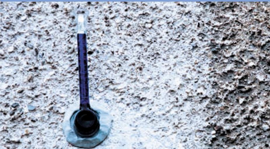
Usando o método do tubo Karsten para testar a hidrorrepelência na mesma fachada em 2008.
