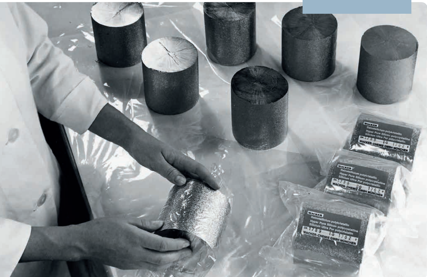
Prüfung und Verpackung von Reinstsilicium in Burghausen (o. - 1965) sowie der Versand von Polysiliciumblöcken (u. - 1968)
