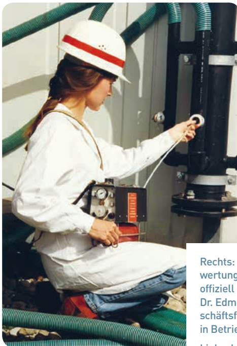
Links: Laborantin Irene Ober bei einer Kontrollmessung gereinigter Abluft
