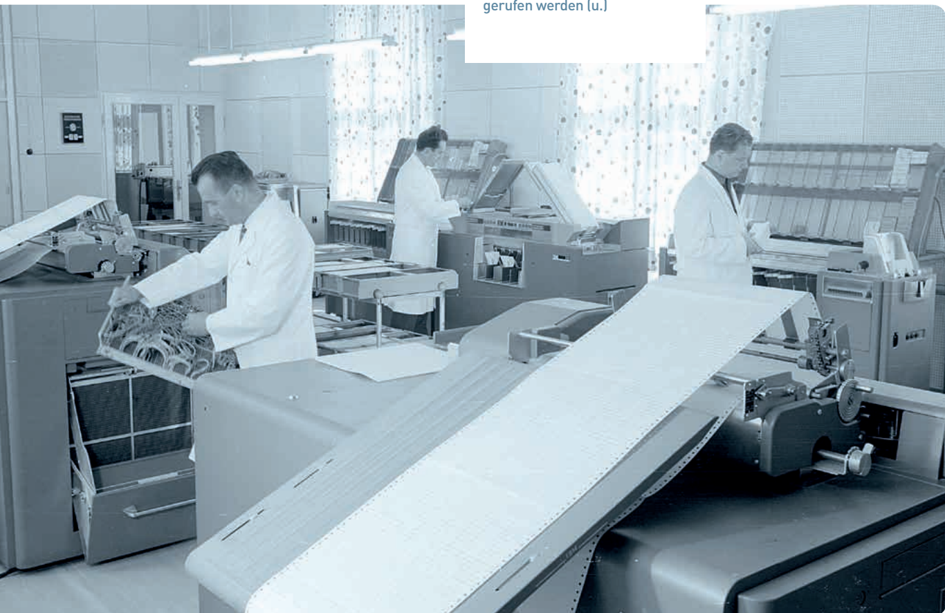
Elektromechanische Datenverarbeitung: 1964 hielten Hollerith-Lochkarten-Apparate Einzug in Burghausen. Auf den Lochkarten wurden per Lochcodes Daten erfasst und gespeichert (o.). Mithilfe von weiteren Maschinen konnten die Daten verarbeitet und abgerufen werden (u.)
