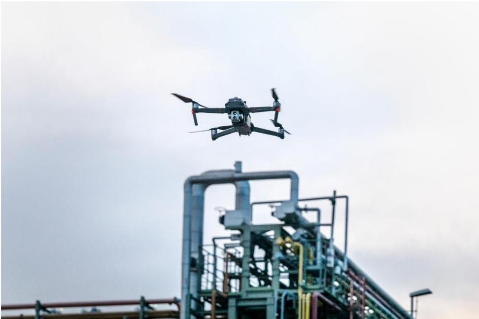
*Bildunterschrift: Mittels einer an der Drohne angebrachten Wärmebildkamera werden Transmissionsverluste von Außenbauteilen in Anlagen, Gebäuden und Rohrbrücken sowie undichte Gebäudehüllen am Standort identifiziert.*
