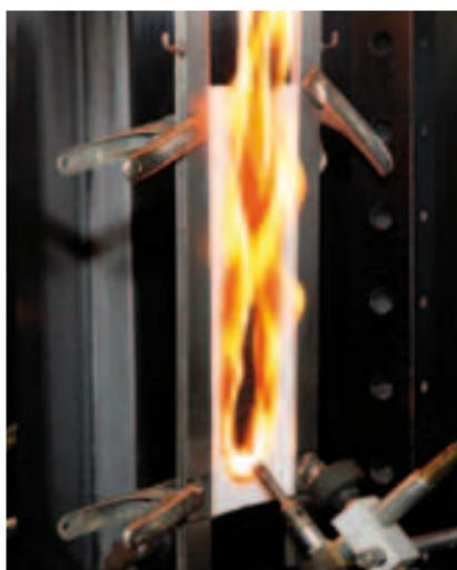
Новая дисперсия VINNOL® CEN 2752 с пониженным содержанием формальдегида находит особое применение для обработки тканей с высокими требованиями по огнестойкости. Лабораторные испытания показывают, проходят ли такие ткани тесты на огнестойкость (левый снимок) или легко воспламеняются (правый снимок).
