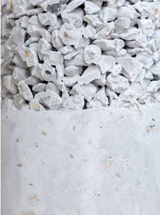
密实、稳定：在本案例中，自充填混凝土砂浆将下半部分的石缝填满。
