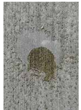
从图中的滴液法测试可以清楚看到，经ETONIS®改性的混凝土能够可靠防止水的侵蚀。
