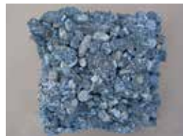
不含ETONIS®: >2,500g/m 2 (经历12次冻融循环后被破坏)
