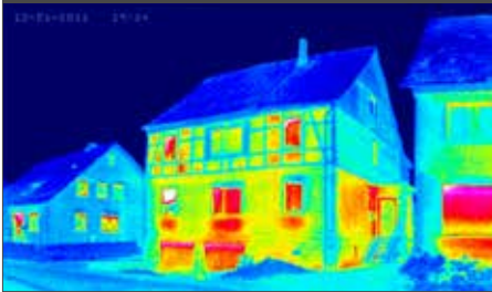
Rysunek 2: Obrazy termiczne fasad: Domy po lewej i prawej stronie są dobrze izolowane, podczas gdy ten w środku nie jest.
