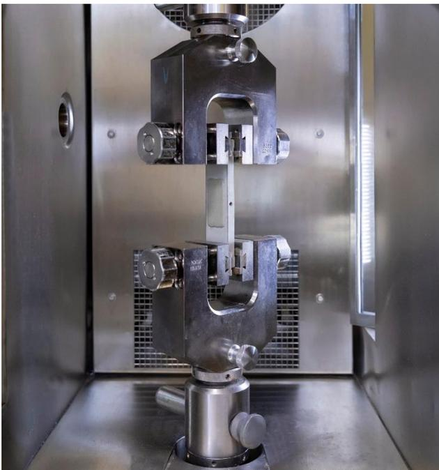
Rissüberbrückungstest nach EN 14981: Dichtungsschlämmen, die mit VINNAPAS® 754 ED und VINNAPAS® 764 ED formuliert wurden, können auch bei Temperaturen unter dem Gefrierpunkt noch Risse ausgleichen. Auf diese Weise ist das Bauwerk vor eindringendem Wasser zuverlässig geschützt. (Foto: WACKER)
