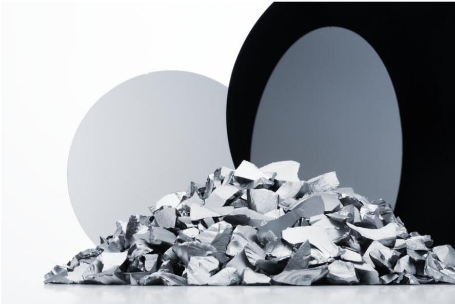
Polysilicium, das für die Herstellung von Halbleiterwafern verwendet wird, erfordert eine extrem hohe Oberflächenreinheit. Am Standort Burghausen baut WACKER jetzt seine Kapazitäten für die Reinigung von Polysilicium in Halbleiterqualität aus. (Foto: Wacker Chemie AG)
