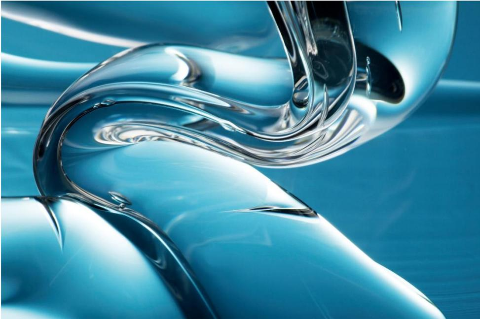
Wärmeleitfähige Siliconmassen von WACKER werden in der Automobil- und Elektronikindustrie unter anderem als Gap-Filler zum Wärmemanagement eingesetzt. Der Konzern produziert solche Spezialsilicone nun auch in Japan. (Foto: WACKER)
