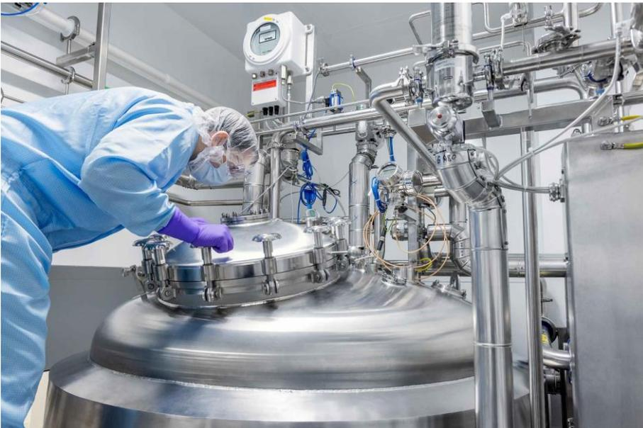
在大型不锈钢罐中储存用来配制 mRNA 活性成分的脂质。（照片：瓦克）
