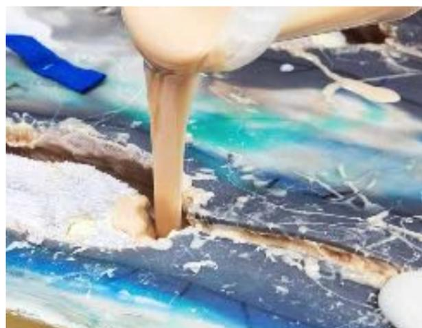
Der gut gießbare Siliconkautschuk wird in einem Hautton eingefärbt.
