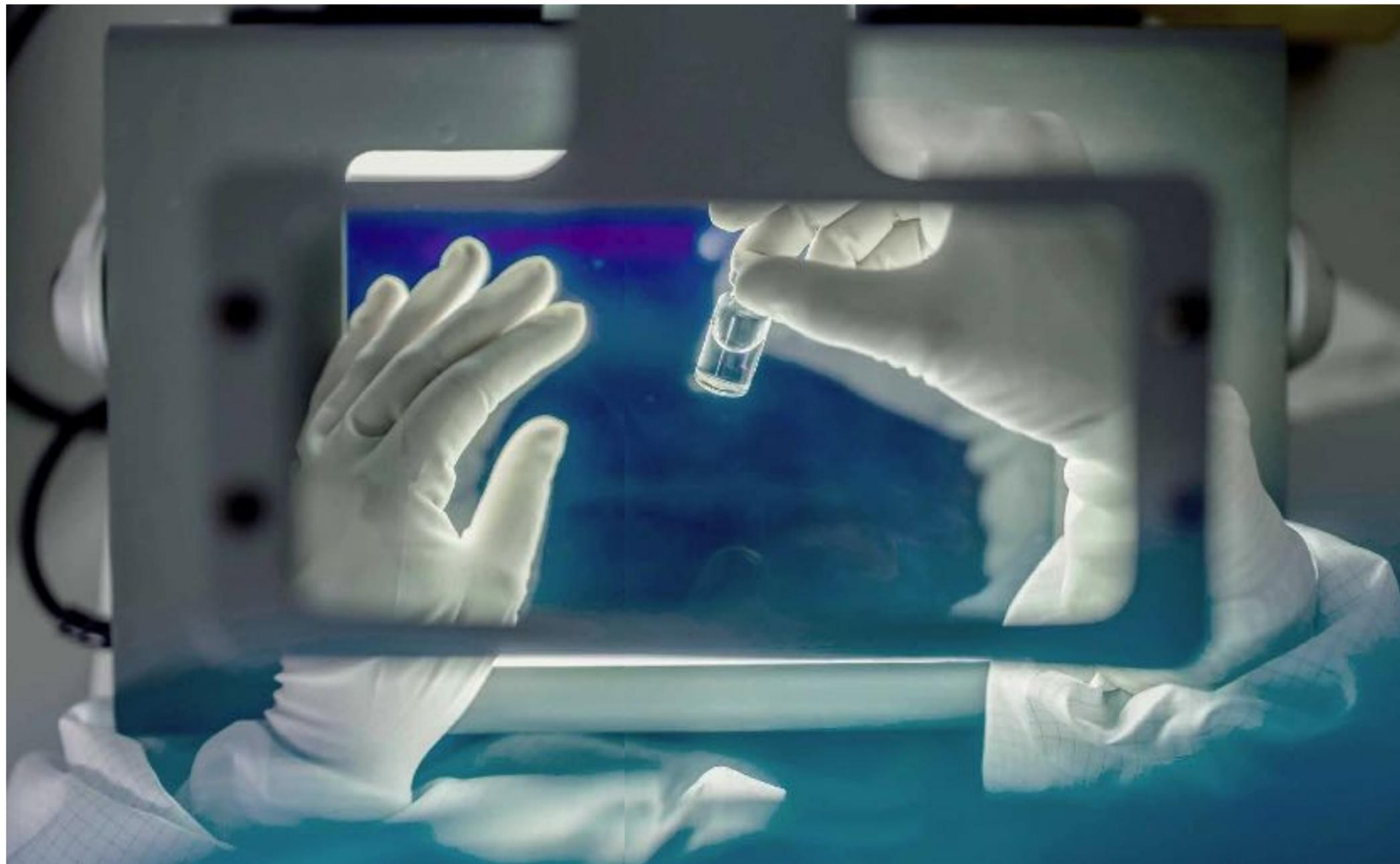
Nach dem Befüllen werden die Fläschchen noch einmal mit bloßem Auge kontrolliert.
