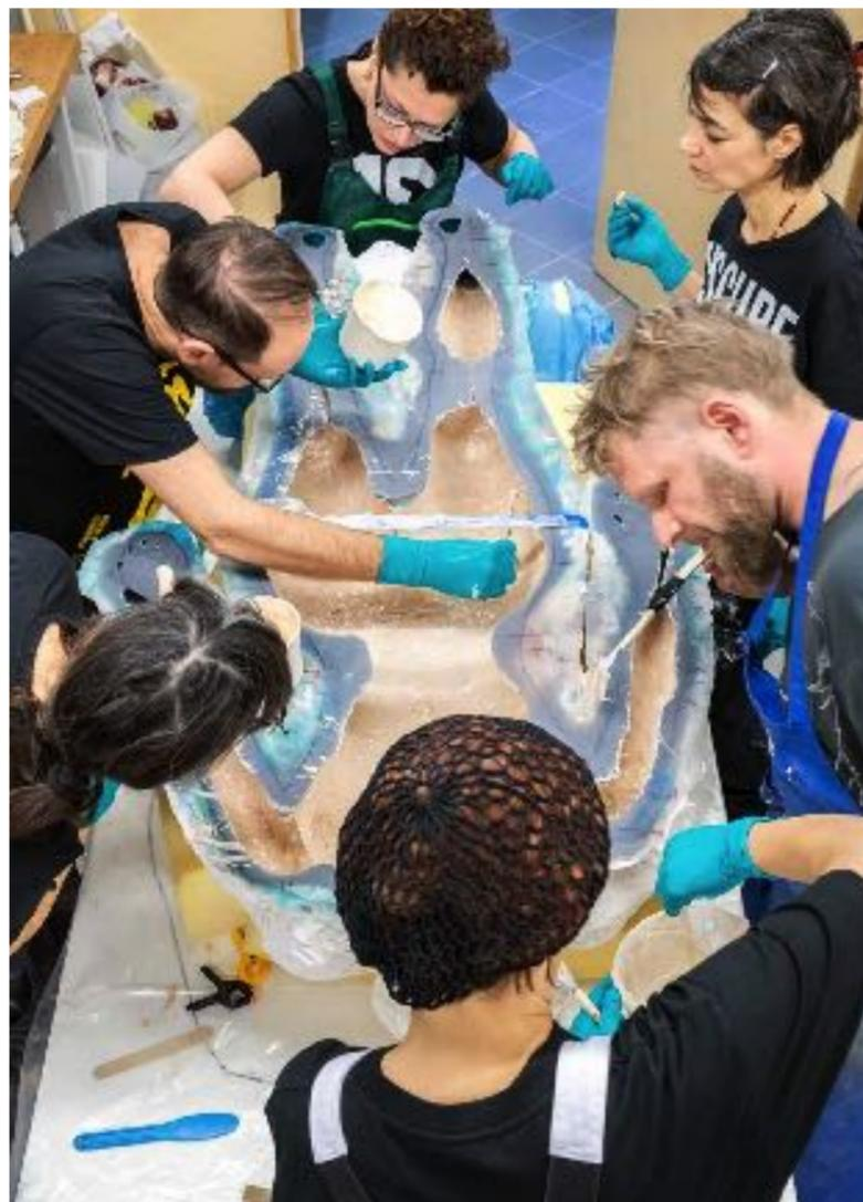
Während der Anfertigung der Positivkopie arbeiten die Maskenbildner unter Hochdruck und mit höchster Konzentration. Da das Material in wenigen Minuten vernetzt, muss der ganze Prozess schnell gehen.
