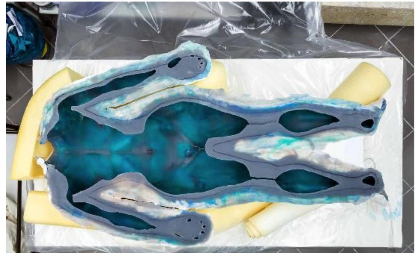
Die Negativform aus Siliconkautschuk, bevor sie mit einem Trennmittel eingestrichen wird, sodass anschließend eine hautfarbene Positivkopie, ebenfalls aus Silicon, erstellt werden kann. Um die Materialien besser auseinanderhalten zu können, ist die Negativform blau eingefärbt.
