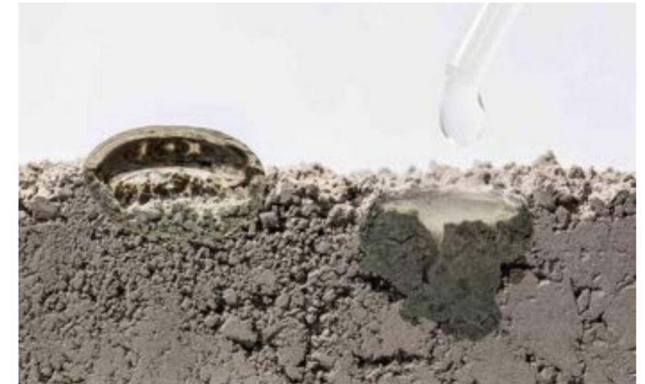
Hydrophobierter (links) und nicht hydrophobierter Zement (rechts) im Tropfentest.
