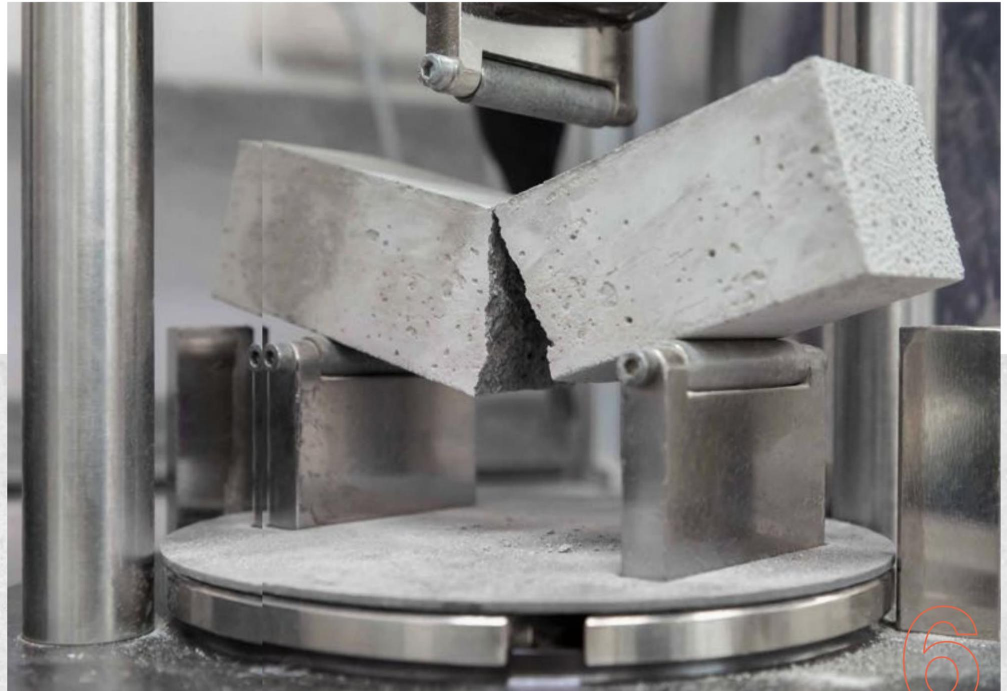
Mit diesem Gerät wird die Biegezugfestigkeit der Prüfkörper aus Beton bestimmt.
