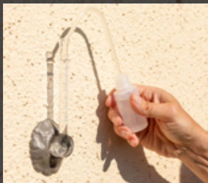
Der Karsten-Röhrchen-Test simuliert einen Regenguss bei Starkwind. Hier zeigt sich: Selbst an Rissen dringt kein Wasser in die Fassade ein.
