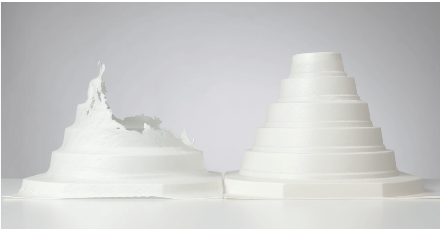
与含滑石粉的常规PBS/PLA共混物（左图）相比，加入VINNEX®粉末后的PBS/PLA共混物可用于吸塑成型（右图）。
